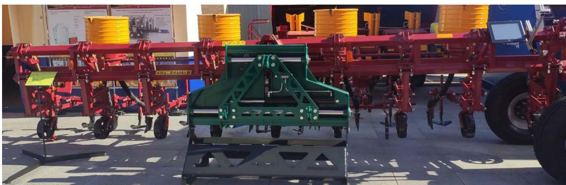
Рис. 2. – Автоматическая управляемая навесная система в агрегате с пропашным культиватором (BELAGRO 2021)
