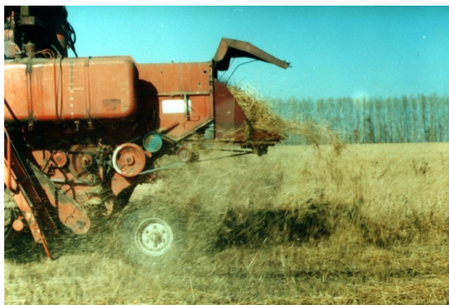
Рис 2. Технологический процесс разбрасывания соломы дисковым разбрасывателем за зерноуборочным комбайном СК-5 «Нива»
