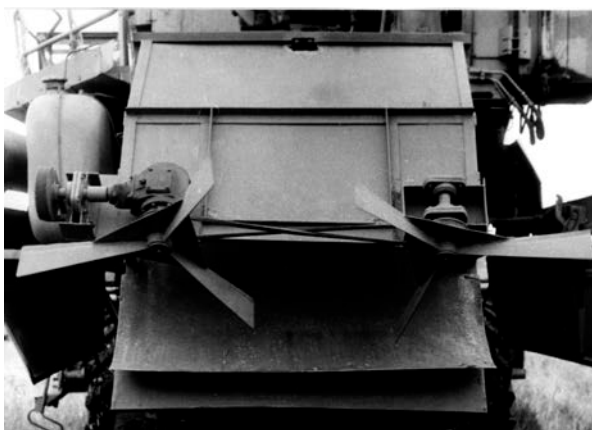
Рис 1. Лопастной разбрасыватель соломы РСЛ-2 установленный на зерноуборочном комбайне «Енисей-1200»
