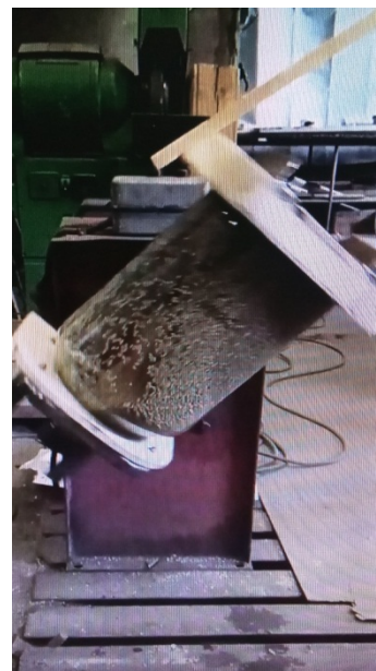
Рис. 3. Вид на прозрачную емкость в момент начала интенсивного разрыхления зерна пшеницы в водно-воздушной среде со стороны загрузки емкости после ее переворачивания против часовой стрелки с 90 до 135 градусов
