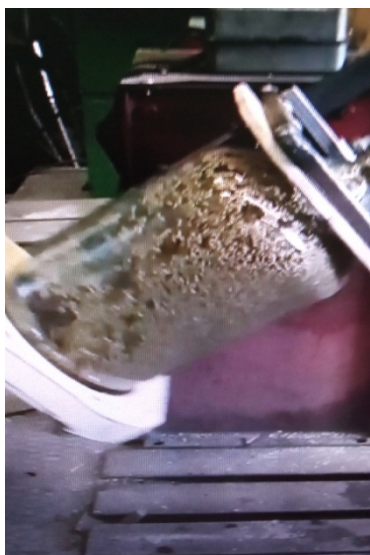
Рис. 4. Вид на прозрачную емкость в момент начала интенсивного разрыхления зерна пшеницы в водно-воздушной среде со стороны дна емкости после ее переворачивания против часовой стрелки с 190 до 315 градусов
