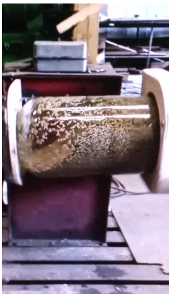
Рис. 2. Вид на прозрачную емкость с началом разрыхления зерна пшеницы в водно-воздушной среде со стороны загрузки емкости после ее переворачивания против часовой стрелки с 45 до 90 градусов
