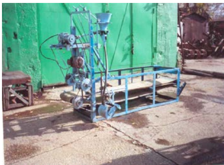
Рис. 2. Общий вид экспериментальной установки для определения качества обработки и размещения семян в полосы
