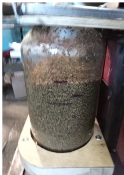
Рис. 5. Вид на прозрачную емкость с разрыхленным зерном пшеницы в водно-воздушной среде после переворачивания емкости с 315 до 360 градусов (после возврата в первоначальное положение)
